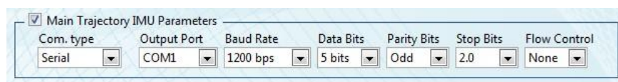
Рисунок 2.73: Конфигурирование оборудования IMU - настройка последовательного порта Serial Configuration: при передаче TCP необходимо указать IP-адрес и порт TCP.
